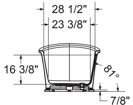
Toutes ces dimensions sont approximatives. Afin d'assurer une installation parfaite, les dimensions de la structure doivent être vérifiées à partir de l'unité.
